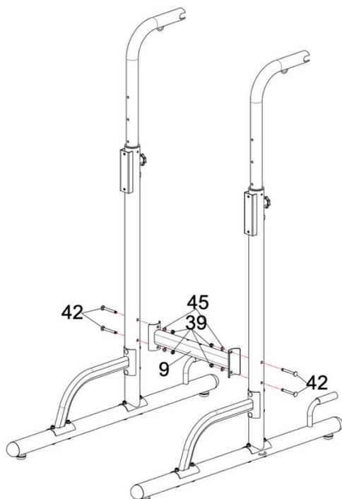
Поместите собранные детали из шагов 1 и 2, а также деталь № 9, как показано на рисунке. Установите болты №42, шайбы №45 и гайку № 39 на деталь №9, чтобы закрепить левую и правую стойки.
