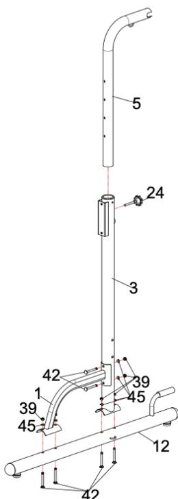
1. Установите детали № 12 и № 3 в соответствии с рисунком, вставьте болт № 42, установите шайбу №45 и гайку № 39, затем закрепите все детали вместе.
