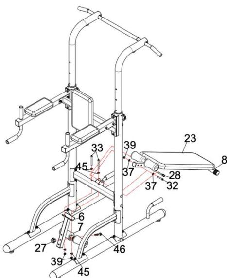
1. Как показано на рисунке, установите деталь № 6 на основную раму, для этого вставьте болт №33, шайбу №45, гайку №39 и закрепите детали.
