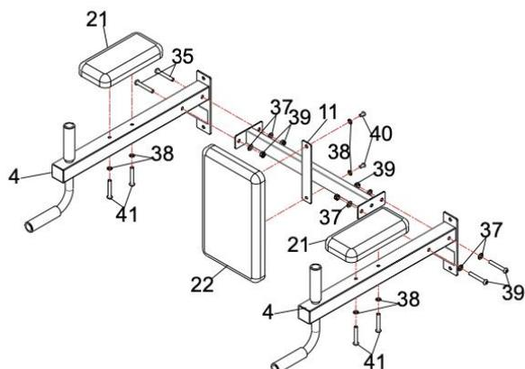
1. Установите детали №11, №4, как показано на рисунке, вставьте болты №35, шайбы №37, шайбы №37 и гайку №39 на детали №11, №4 и затяните. Повторите те же самые действия с другой стороны.
