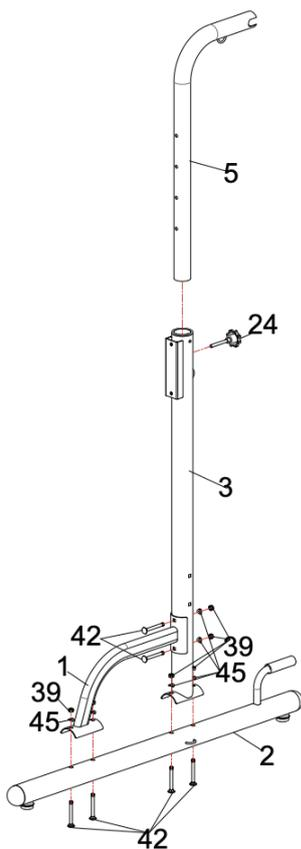
1. Установите детали № 2 и № 3 в соответствии с рисунком ставьте болт № 42, установите шайбу №45 и гайку № 39, затем закрепите все детали вместе.
