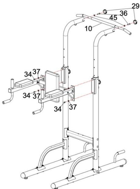
1. Установите собранные детали из шага 4 и вертикальные стойки, как показано на рисунке; с помощью болтов №34 и шайбы №37, зафиксируйте собранные детали на вертикальной стойке. Повторите те же самые действия с другой стороны.
