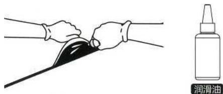
Использование смазки под беговым полотном обеспечит отличную работу и продлит срок службы беговой дорожки. Нанесите немного смазки после первых 25 часов (или 2-3 месяцев) использования и повторно наносите каждый раз спустя 50 часов (или 5-8 месяцев) использования.
