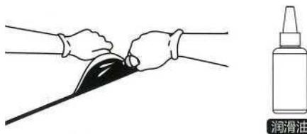
Использование смазки под беговым полотном обеспечит отличную работу и продлит срок службы беговой дорожки. Нанесите немного смазки после первых 25 часов (или 2-3 месяцев) использования и повторно нанесите каждый раз спустя 50 часов (или 5-8 месяцев) использования.
